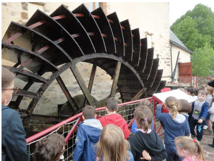
Ouverture de la vanne pour que la roue tourne.
